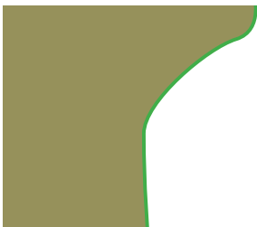
Überhängend, so dass regengeschützte Bereiche entstehen
